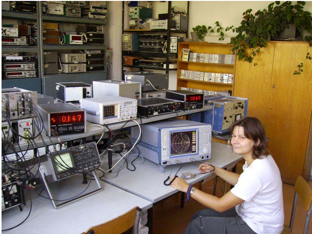
Mgr inż. Małgorzata Gajewska przy pomiarach charakterystyk filtra pasmowo-przepustowego
