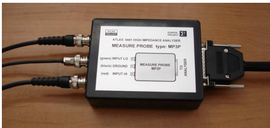
Rys. 30. Wygląd sondy wejściowej dla obiektów nieuziemionych – trójzaciskowej
