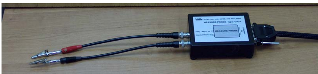
Rys. 32. Wygląd sondy wejściowej dla obiektów uziemionych
