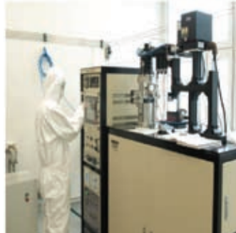
Rys. 8. System PE-CVD do badania technologii nanowarstw DLC. Stanowisko technologiczne PA CVD Seki AXS200S
