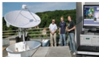
Rys. 23. Satelitarna naziemna stacja odbiorcza 1.5 metre HRPT-MetOp system firmy Dartcom
