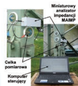
Rys. 10. Pomiary impedancji powłok lakierniczych w terenie na słupie wysokiego napięcia za pomocą miniaturowego analizatora impedancji MAIMP
