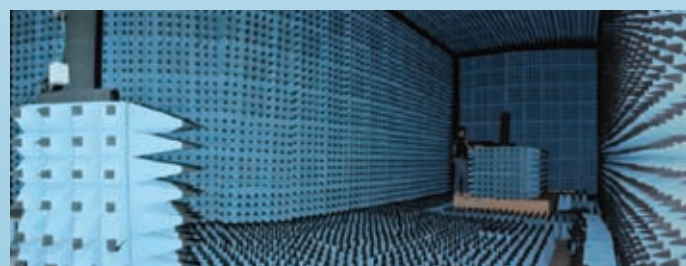
Rys. 7. Wnętrze komory bezechowej do pomiaru anten
