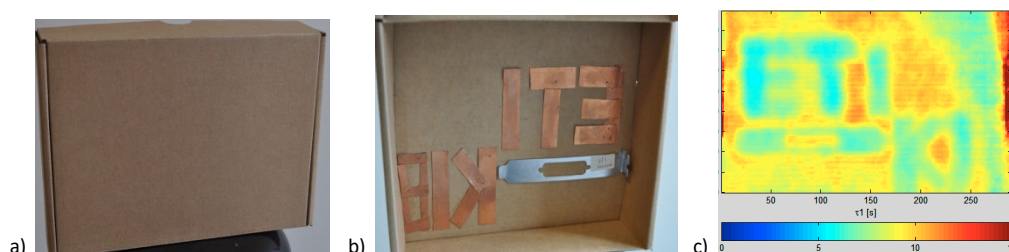
Rys. 8. Badania fantomowe - fantom 2, karton z elementami wyklejonymi; a) fotografia fantomu od strony badanej, b) fotografia wnętrza fantomu, c) uzyskany obraz parametryczny ATD - stała czasowa \tau_1
