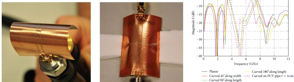
Rys. 15. Filtr pasmowo przepustowy wykonany z folii przewodzącej oraz wyniki pomiarów współczynników rozproszenia.
