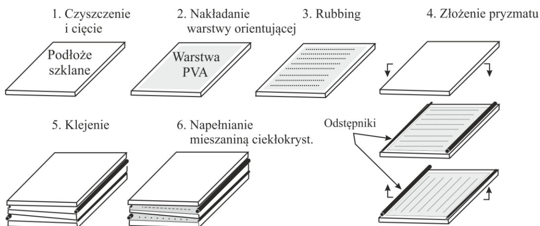
Rysunek 9. Przebieg procesu wykonywania pryzmatu Wollastona z ciekłymi kryształami
