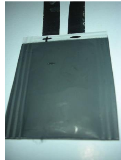
Badane prototypowe superkondensatory (o pojemności ok. 2 F)
